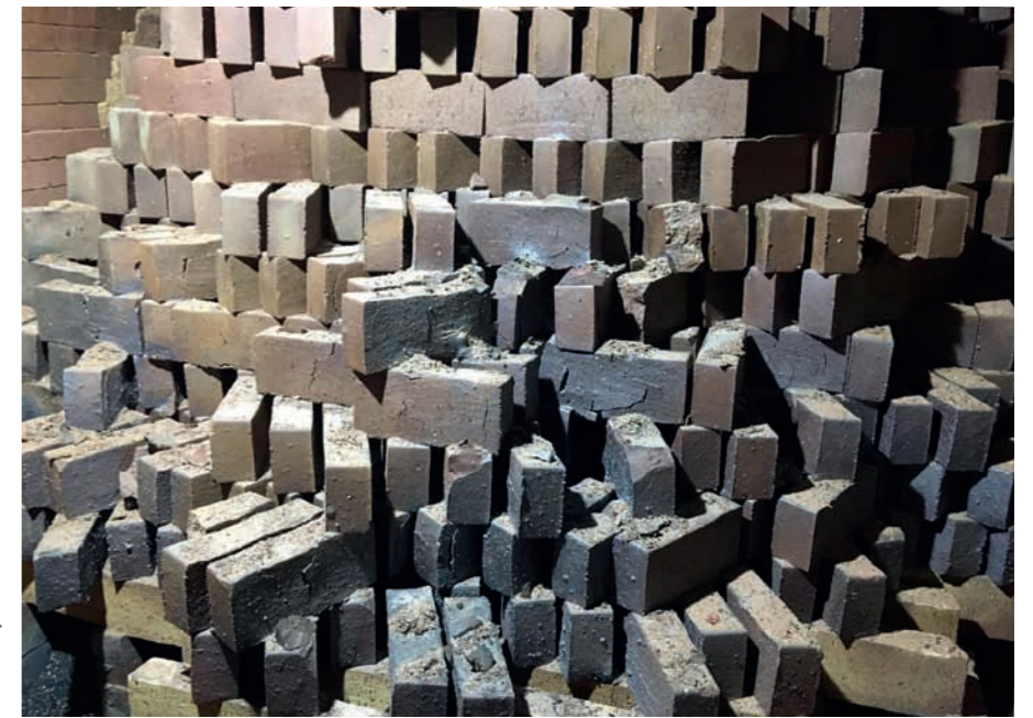
Beim diesjährigen Brand sind aufgrund sehr hoher Temperaturen viele Steine ineinander verschmolzen.
